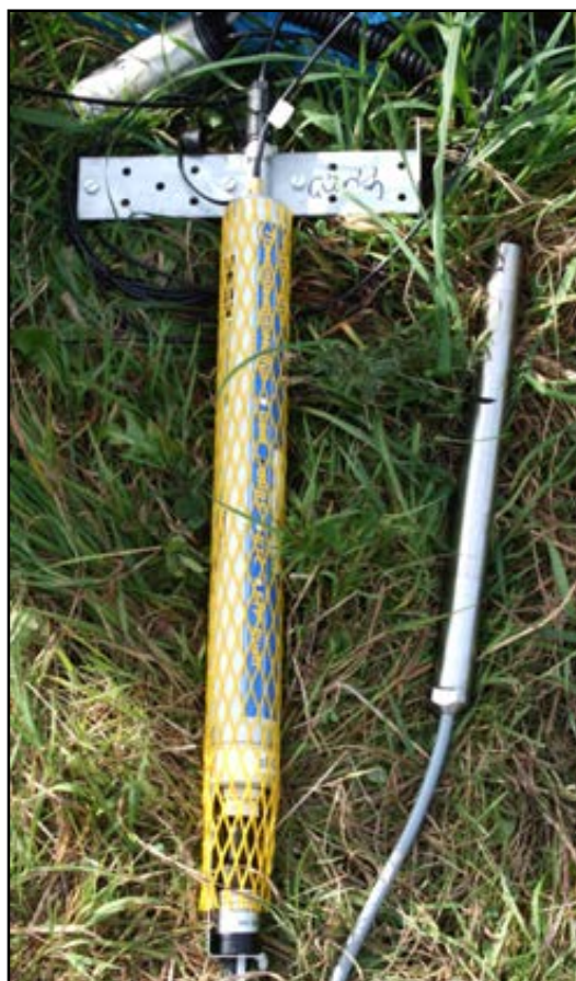
Abbildung 5: Grundwassermessstelle Pegel Gürth (GUE). Links: SEBA-Druck-/Temperatursonde Dipper T3 mit SlimCom-Modul für die Datenfernübertragung und Brunnenrohr, auf dessen Deckel die Puckantenne montiert ist. Rechts: Detailansicht von p/T-Sonde (r) und SlimCom-Modul (l).
