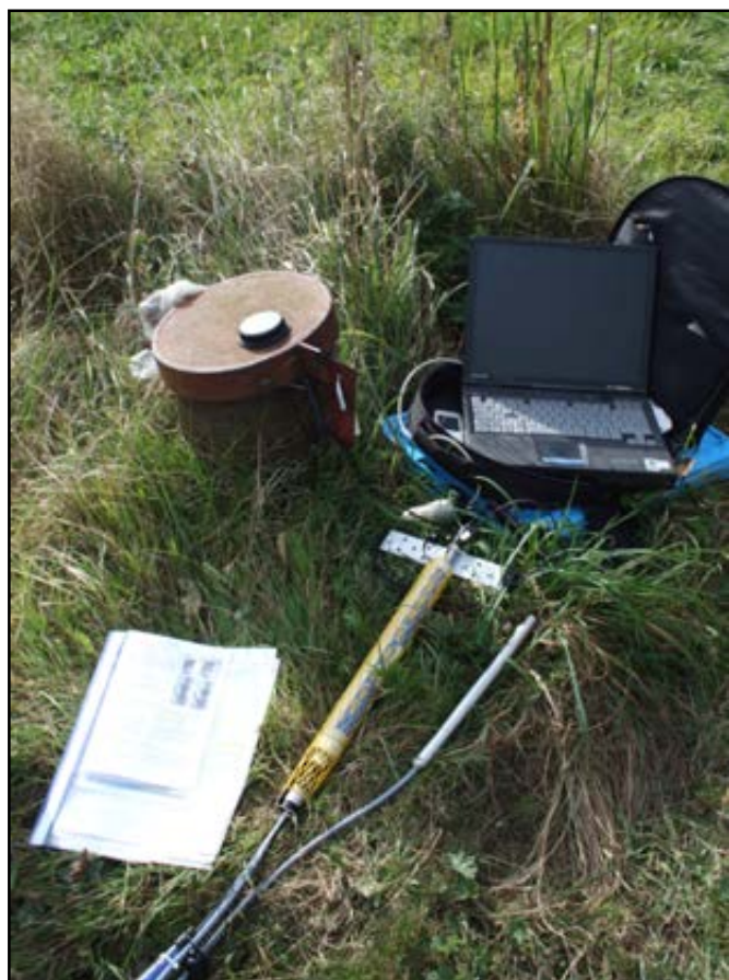
Abbildung 5: Grundwassermessstelle Pegel Gürth (GUE). Links: SEBA-Druck-/Temperatursonde Dipper T3 mit SlimCom-Modul für die Datenfernübertragung und Brunnenrohr, auf dessen Deckel die Puckantenne montiert ist. Rechts: Detailansicht von p/T-Sonde (r) und SlimCom-Modul (l).
